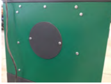
Filtre temizleme kapağı
